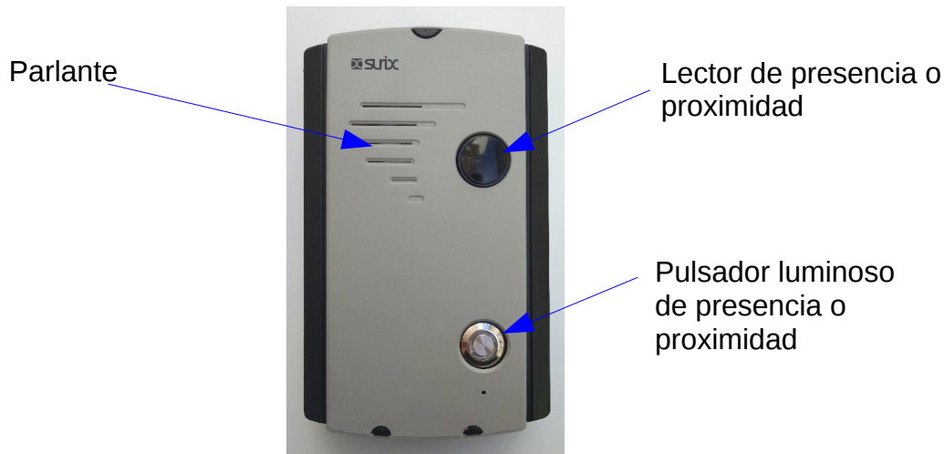
Figura 9 – Terminal de llamada con lector de presencia
