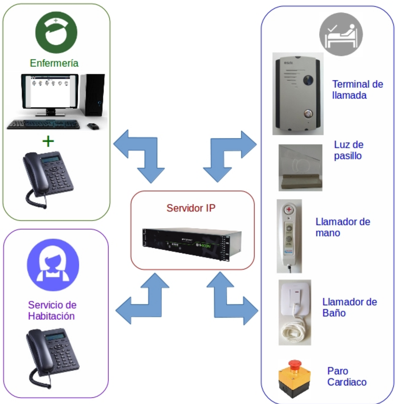
Figura 5 – Esquema de comunicación entre Enfermería, Servicio de Habitación y Habitación a través de la Servidor IP
